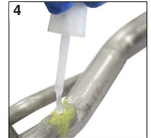
Attendere 20" per ottenere una riparazione che resista ad una pressione di 20 Bar e 20 min (a una normale temperatura ambiente di 20°C) affinché resista ad una pressione di 50 Bar e 250°C.
